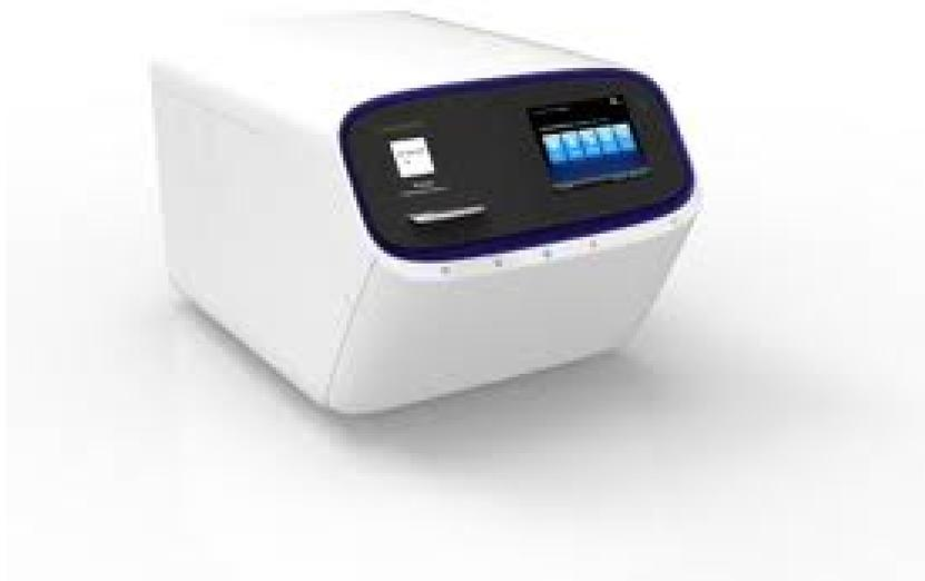
C'est une machine pas plus grande qu'une photocopieuse, qui permet de décoder l'ensemble du génome d'une personne en deux heures et pour moins de 1 000 dollars, selon son fabricant. Ion Proton Sequencer, cet appareil qui décrypte les trois milliards de « paires de base » du génome
